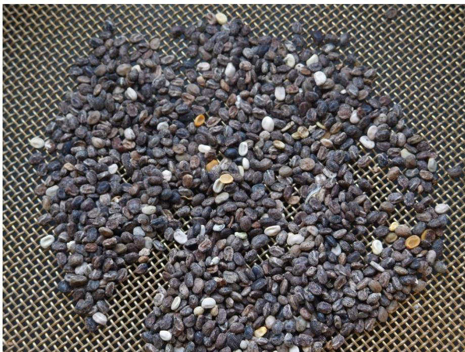
Figura 12. Semillas de *Lupinus* separadas con los tamices graduadas.
