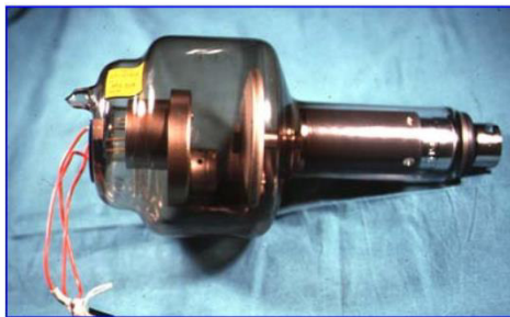
Figura 2.3. Tubo de ánodo giratorio
