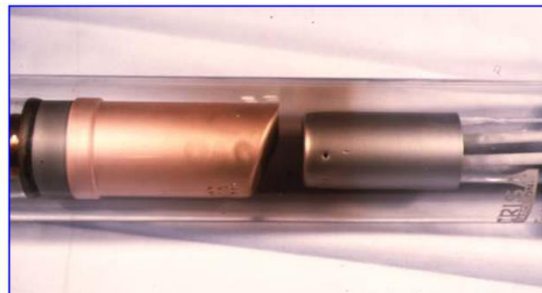
Figura 2.4. Tubo de ánodo fijo
