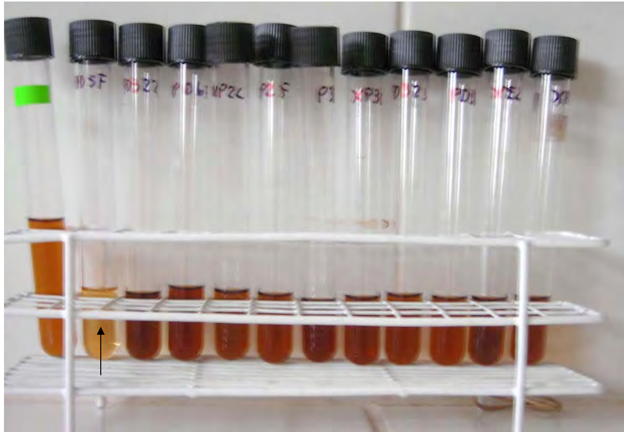
Figura 11. Prueba cualitativa de la degradación de lignina. Obsérvese que el segundo tubo (Cepa PD5F) ha sido el único que ha virado de color.
