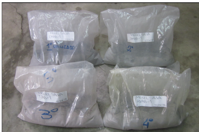
Figura N° 17: Muestras pulverizadas de los 4 componentes mineros, para realización de los ensayos biotóxicológicos.
