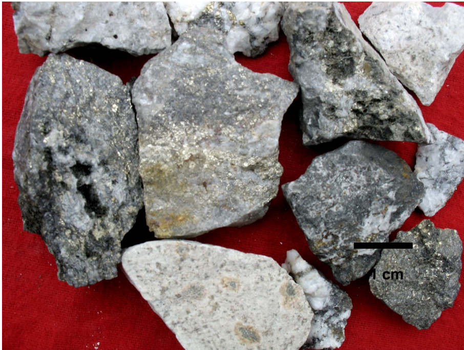
Fragmentos de roca volcánica andesita silicificada y en menor proporción pórfidos intrusivos dioríticos mostrando silicificación y caolinización con sulfuros diseminados, óxidos de hierro, escasas arcillas y mínimos carbonatos.
