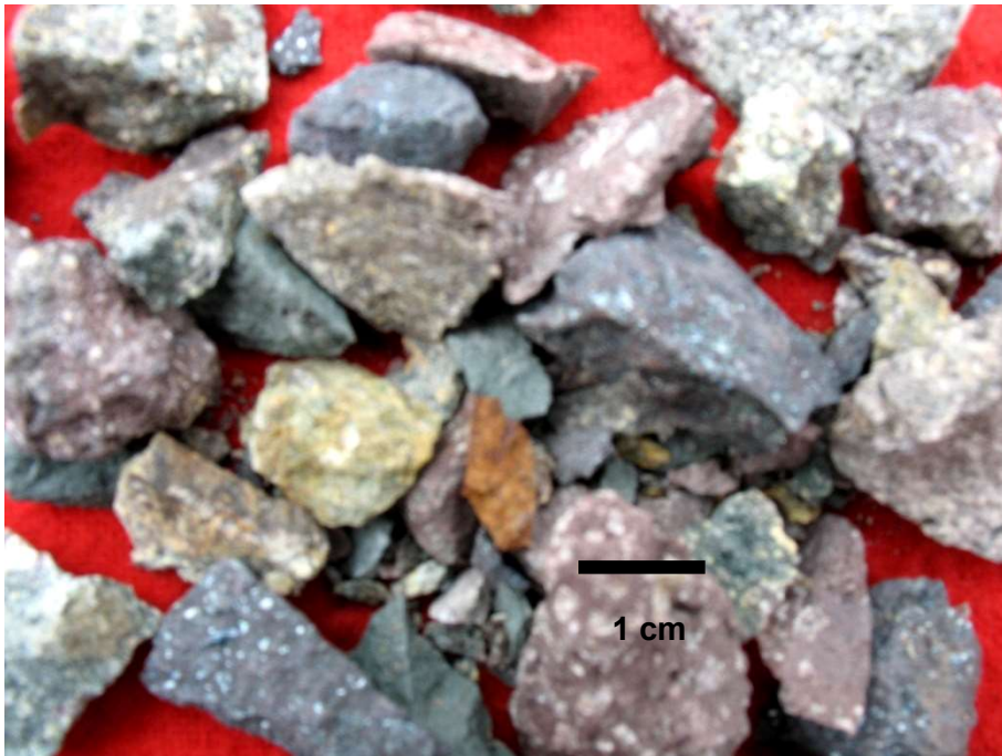
Fragmentos de rocas volcánicas porfíricas de andesitas y dacitas con presencia incipiente de sulfuros con óxidos de hierro.
