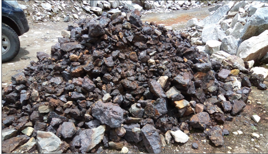
Figura N° 3: Cancha de mineral con alto porcentaje de minerales de cobre, zinc, plomo y hierro.
