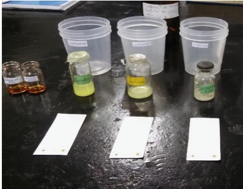
Fig. N°27: Sembrado de muestra en soporte de silica para cromatografía de capa fina con los estándares de quercetina, hesperidina, ácido gálico
