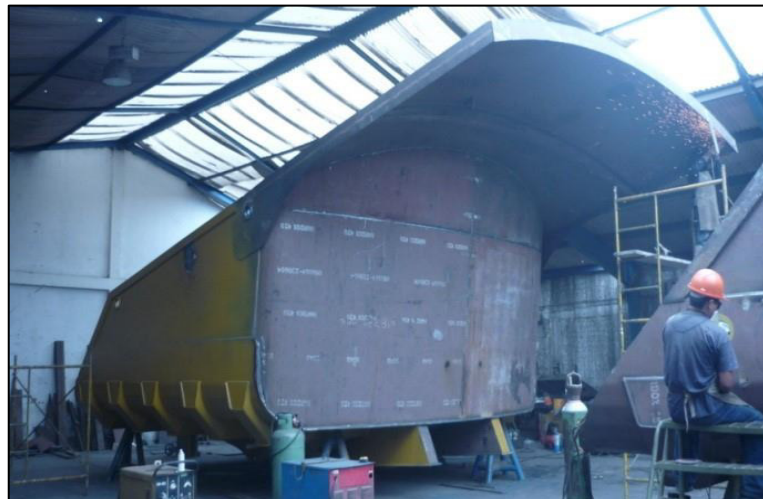
Figura N° 8: Reparación de tolva de camión minero CAT 793 Fuente: La empresa
