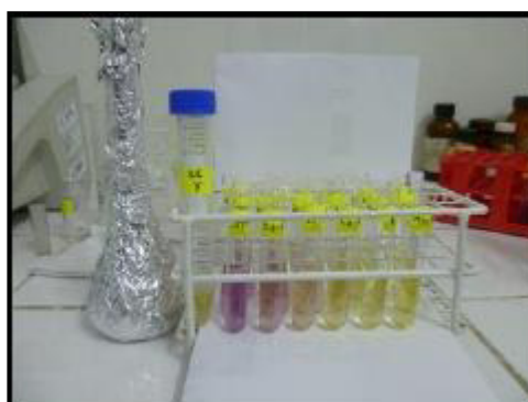
Figura 59. Diluciones del extracto etanólico con solución de DPPH
