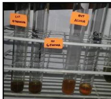
Figura 45. Ensayo de Gelatina.
