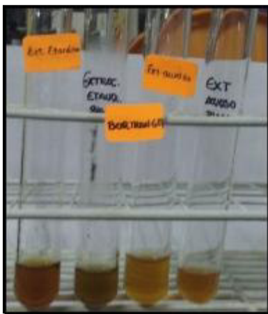
Figura 54. Ensayo de Borntrager.
