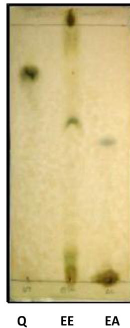
Figura 15. Cromatograma con estándar quercetina y con revelador FeCl_3 10%.
