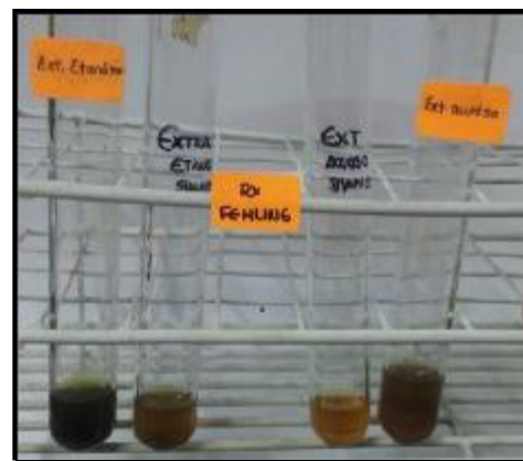
Figura 55. Ensayo de Fehling.
