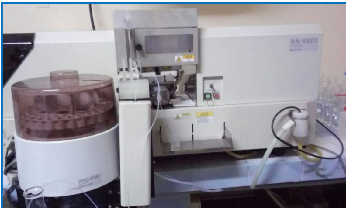
Anexo 10. Equipo de análisis de metales Espectrofotómetro de Absorción Atómica en Horno de Grafito
