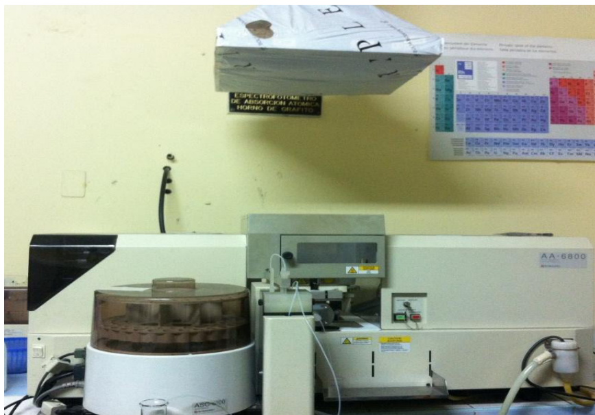
Figura 9. Espectrofotómetro de absorción atómica con horno de grafito Marca SHIMADZU, Modelo AA6800. Laboratorio USAQ.
