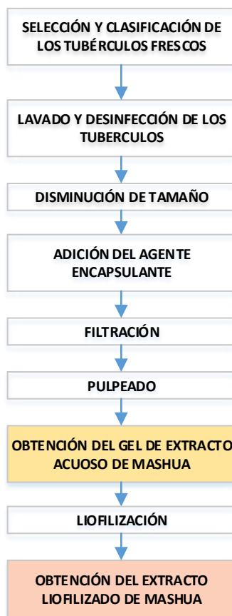
Figura 6. Flujograma de la obtención del extracto liofilizado Fuente. Propia
