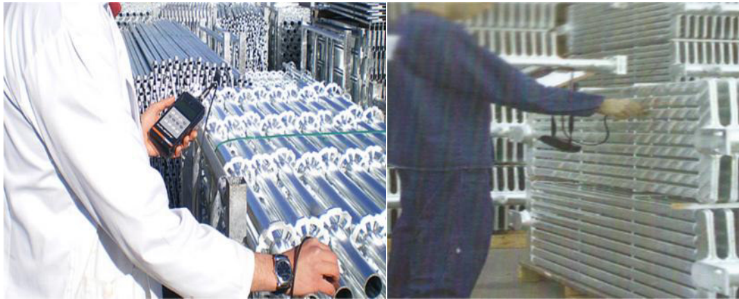
FIGURA 9.1: Mediciones al recubrimiento de zinc de manera sencilla (equipos especializados)
