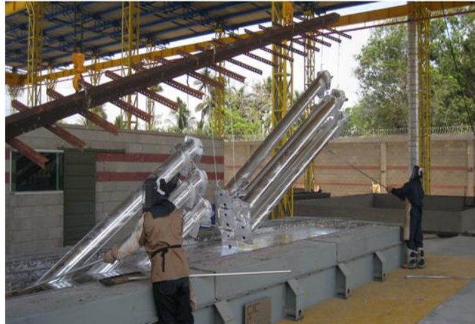
FIGURA 1.1: Proceso de inmersión en caliente.
