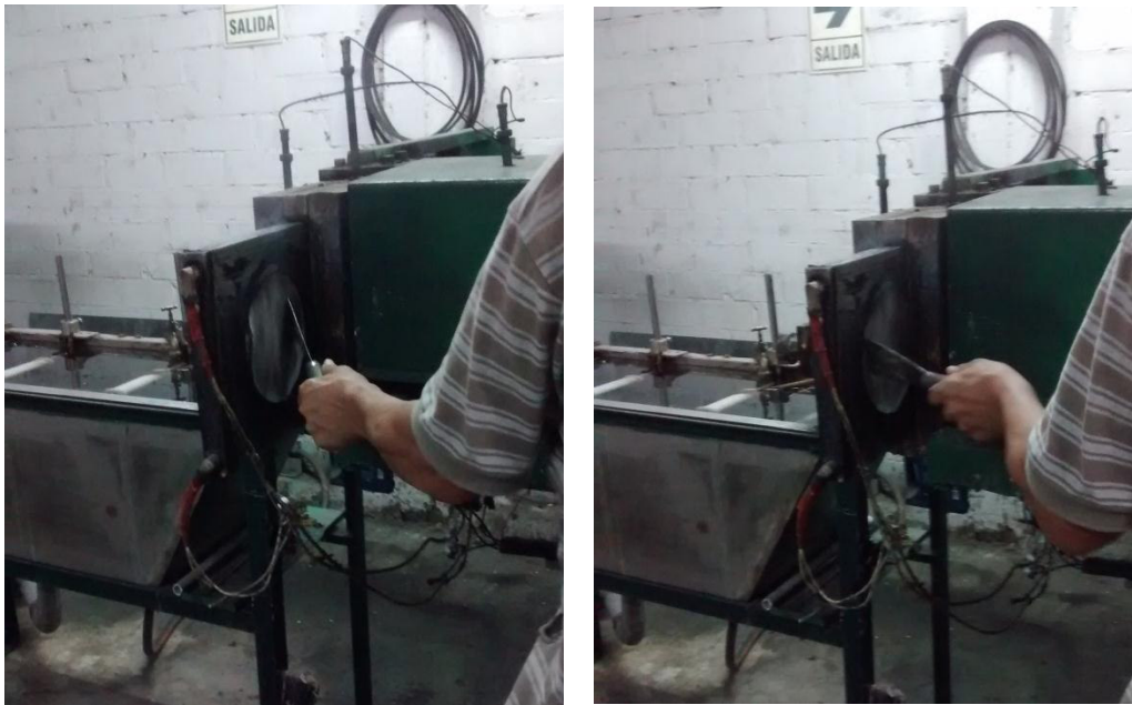
Figura 1.6 Colocación de malla en el cabezal
