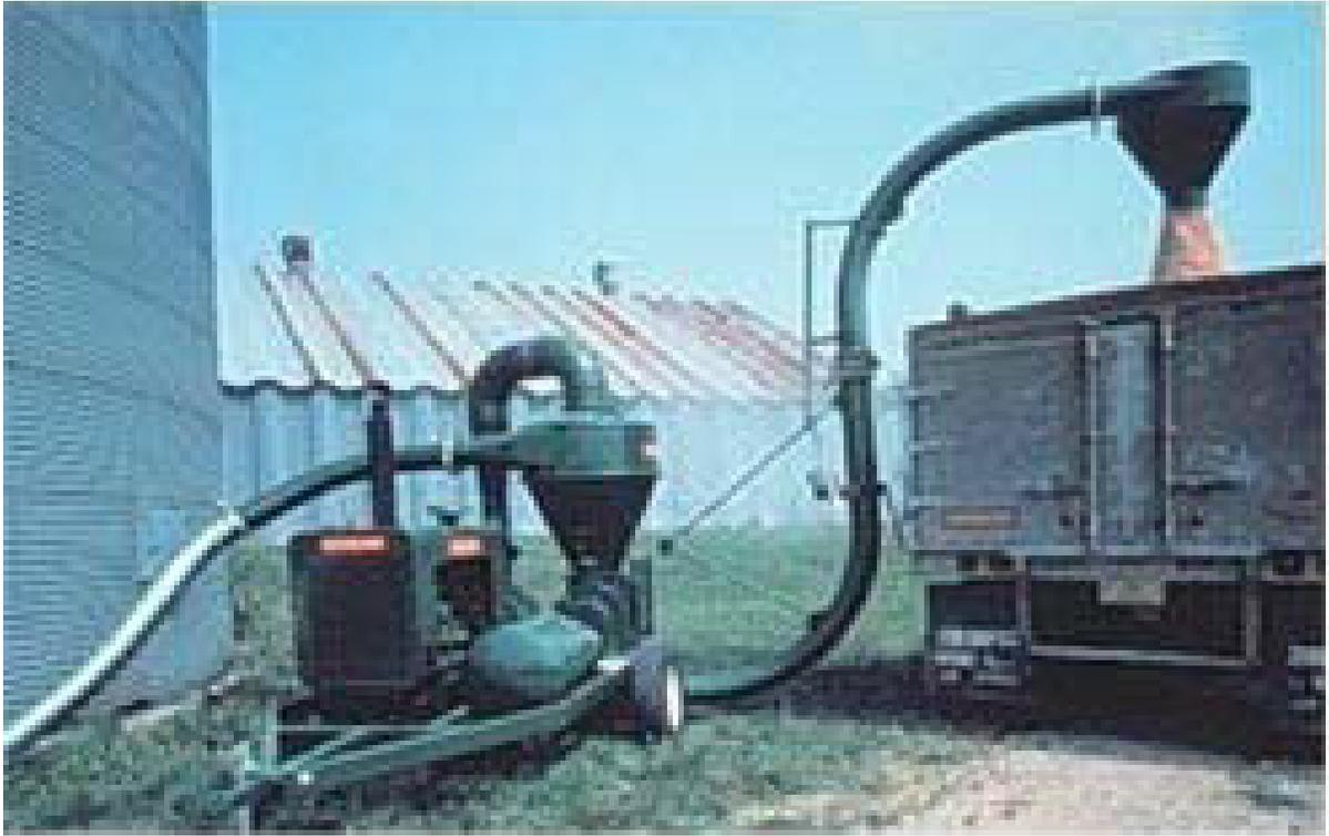
Figura 2. Planta succionadora de grano
