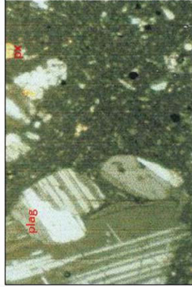
Microfotografía 12. Muestra Ma-030900 (75X), argilización débil, cloritización, serpentización, oxidación incipientes; aglomerados de plagioclasa, piroxenos y opacos, finas venillas de cloritas y óxidos de Fe.
