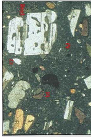
Microfotografía 19. Muestra Ma-270600 (75X), la matriz es criptocristalina, en sectores con apariencia fluidal marcada por diminutos minerales tabulares de FPs. Los fenos de bt y ANFs subidiomórficos a idiomórficos.
