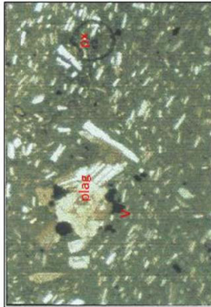
Microfotografía 03. Muestra HU-SO-70 (150X), abundantes y diminutos cristales de minerales opacos en la matriz, fenos de plagioclasas parcialmente corroídos por vidrio de la matriz.
