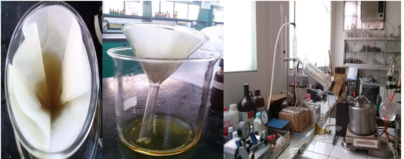
Fig. 29 Se filtró la solución con papel filtro, se concentró en Rotavapor Heidolph VV2000, la solución se llevo a evaporación por calor seco en estufa a una temperatura de 60°C hasta su completa evaporación.
