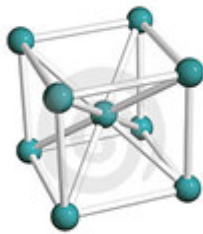
Figura 3.16 Estructura del Cu.
