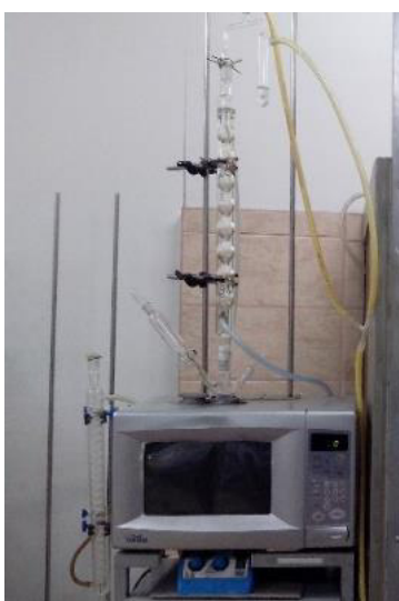
Figura 7.9 Microondas adaptado para síntesis química del LQCNM.
