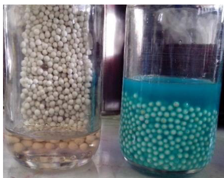
Figura 8.7 A la derecha solución de \text{CuAc}_2 (M1) y a la izquierda solución de AA y PVP, ambos disueltos en el plastificante mediante MH.
