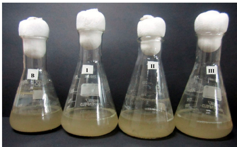
Figura 17. Cultivos por triplicado del consorcio QuF1 (I, II y III) y un cultivo control (B) en medio mínimo suplementado con un mineral azufrado que contenía calcopirita.
