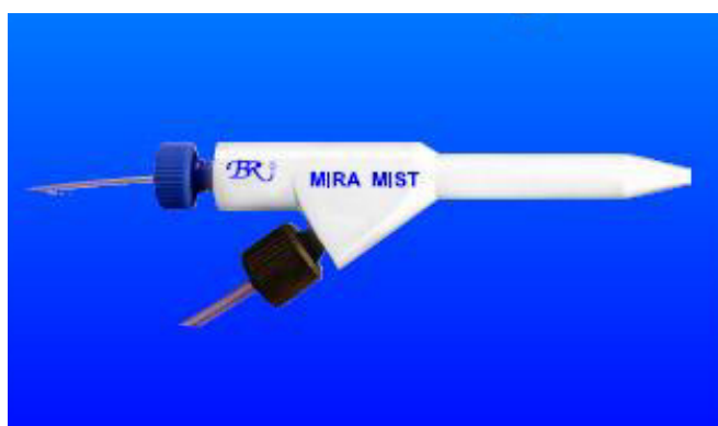
Figura 17: Nebulizador Mira Mist de teflón fabricado por Burgener (Tomado de ref. 20)
