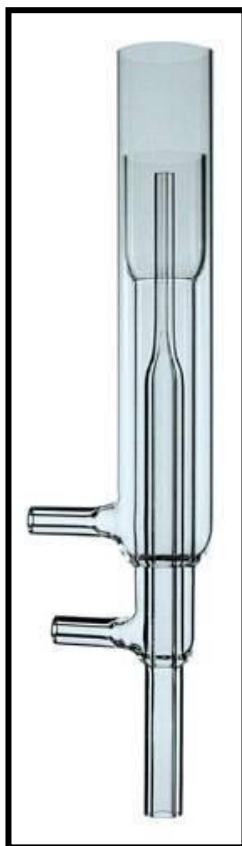
Figura 31: Antorcha de cuarzo para ICP OES VARIAN vista Radial (Tomado de ref. 30)
