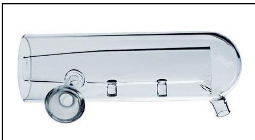
Figura 23: Cámara de nebulización de doble paso (tomado de la ref. 24).
