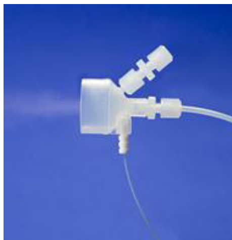
Figura 15: Nebulizador de flujo cruzado PFA de Savillex. El orificio de gas del nebulizador y el orificio de la muestra están posicionados en 90° (Tomado de la ref. 18)
