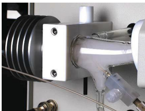
Figura 21: Aerosol obtenido por un nebulizador ultrasónico (Tomado de la ref.23)
