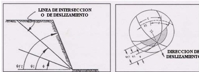
**Fig. 81 Línea de deslizamiento**
