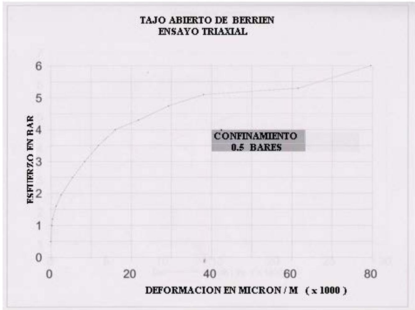
**Fig. 29** Ensayo triaxial para un confinamiento de 0.5 bar
