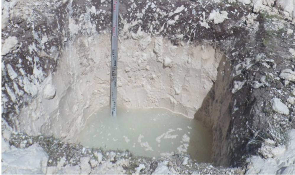
Figura N° 2-3.- Suelo formado por limos diatomáceos (Fuente: E&E Perú S.A. – Trabajos de Campo).
