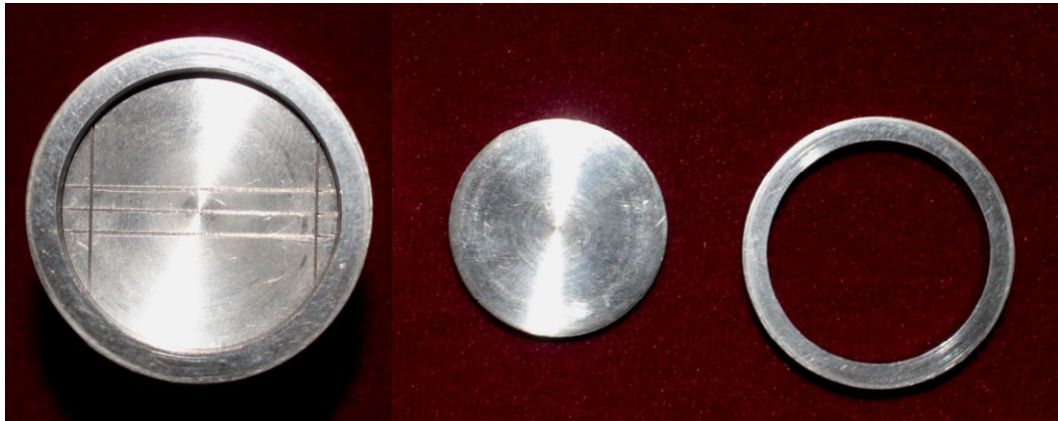
Tres partes constituyentes de alta precisión del dispositivo metálico: cuerpo del dispositivo o área de trabajo, disco de arrastre y el anillo o cilindro.
