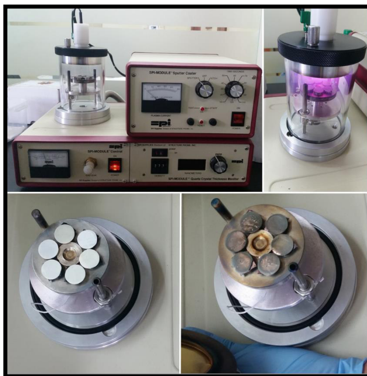
Figura N° 8. Proceso de Galvanización en el SPI MODULE™ Sputter/Carbon Coater.
