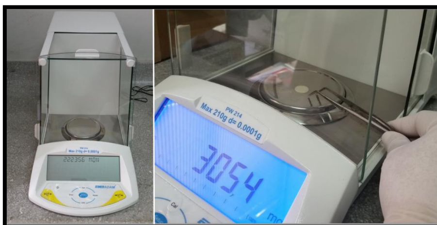
Figura N° 7. Medidas de peso de los discos en la balanza analítica æ ADAM.
