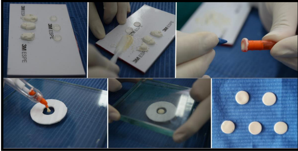
Figura N° 4. Preparación de los discos de ionómero de vidrio.
