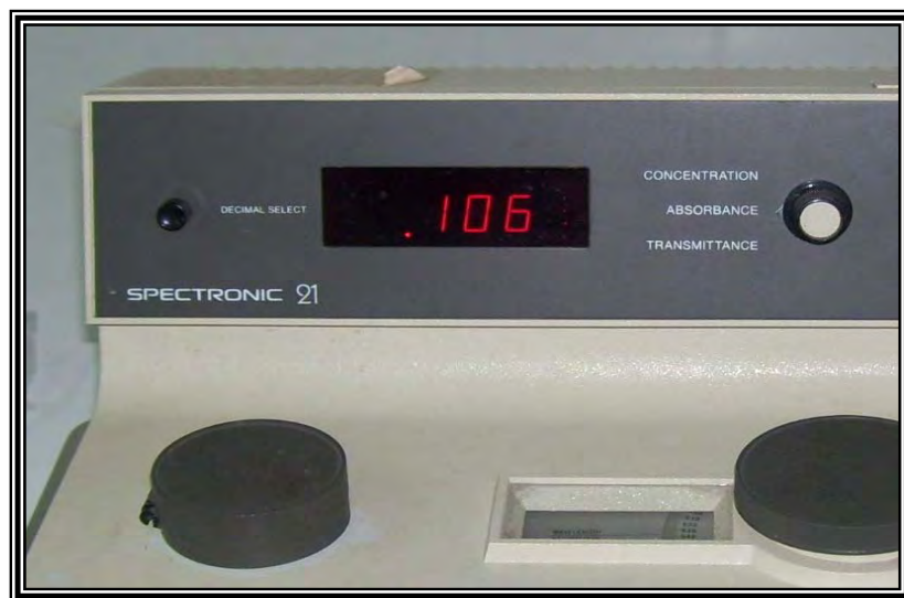
Fig. N° 8: Lectura de absorbancia en el espectrofotómetro
