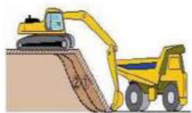
Excavación de cuesta completa
