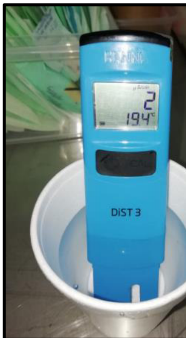
Figura 66: Prueba de Conductividad – Tiva10 2V. Fuente: Propia
