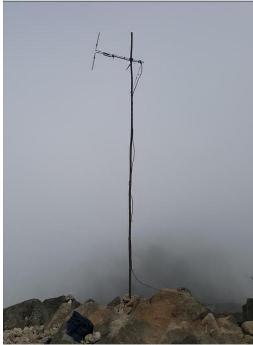
**Figura 9.** Antena Dipolo con polarización vertical
