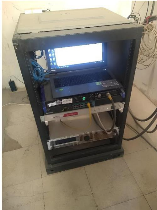
**Figura 22. Conexión remota al analizador de espectro AARONIA**
