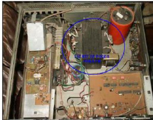
**Figura 15.** Fuente de poder de un transmisor artesanal
