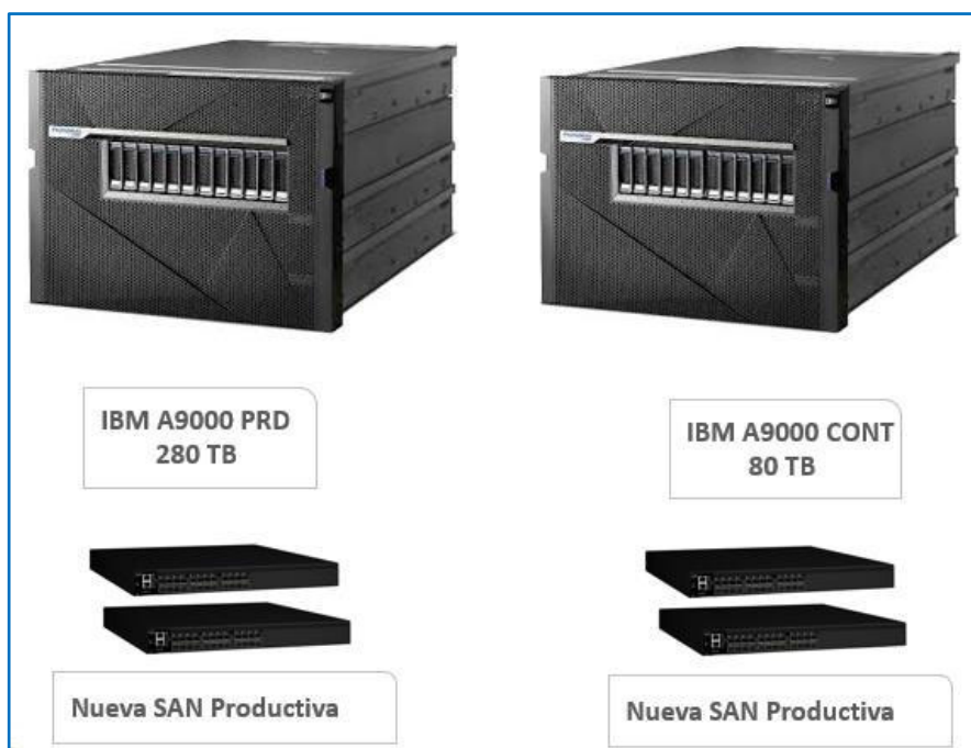
Figura 10. Sistema de Almacenamiento Storage IBM A9000 Fuente: Elaboración Propia
