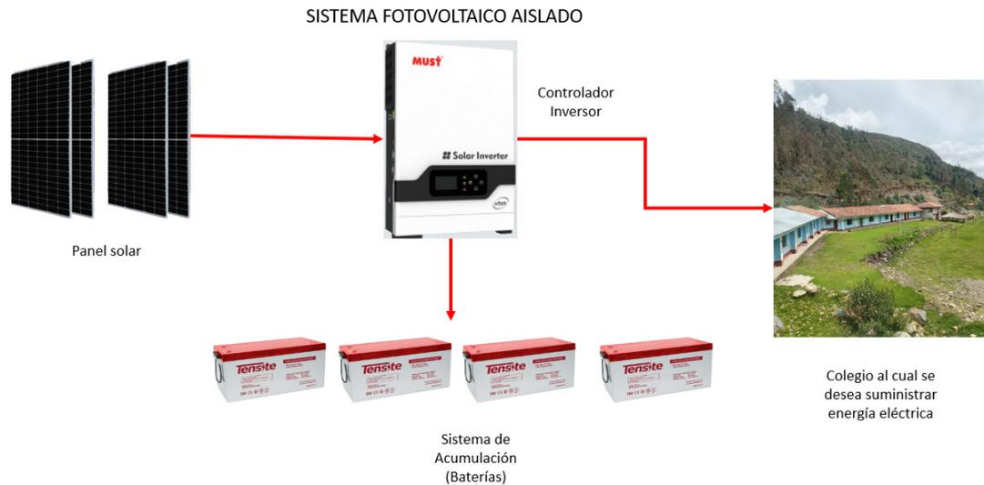
**Figura 14:** Diagrama de Componentes del Sistema Fotovoltaico Aislado. Fuente: Elaboración propia.
