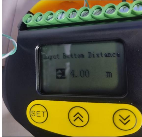
*Figura 47: Configuración del sensor de nivel. Fuente: elaboración propia.*
