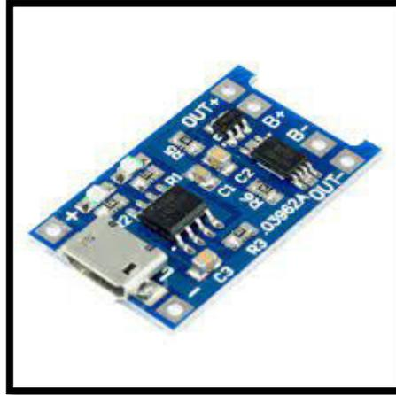
*Figura 14: Módulo TP4056.* Fuente: (Naylamp Mechatronics SAC, 2023).
