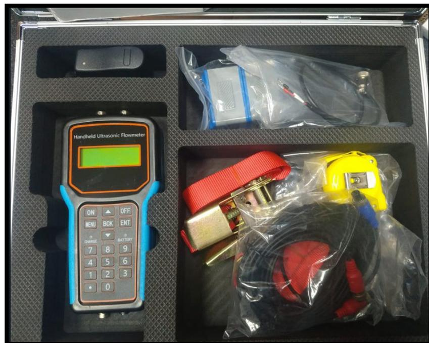
**Figura 5 : Flujómetro ultrasónico KUFH2000B.** Fuente elaboración propia.
