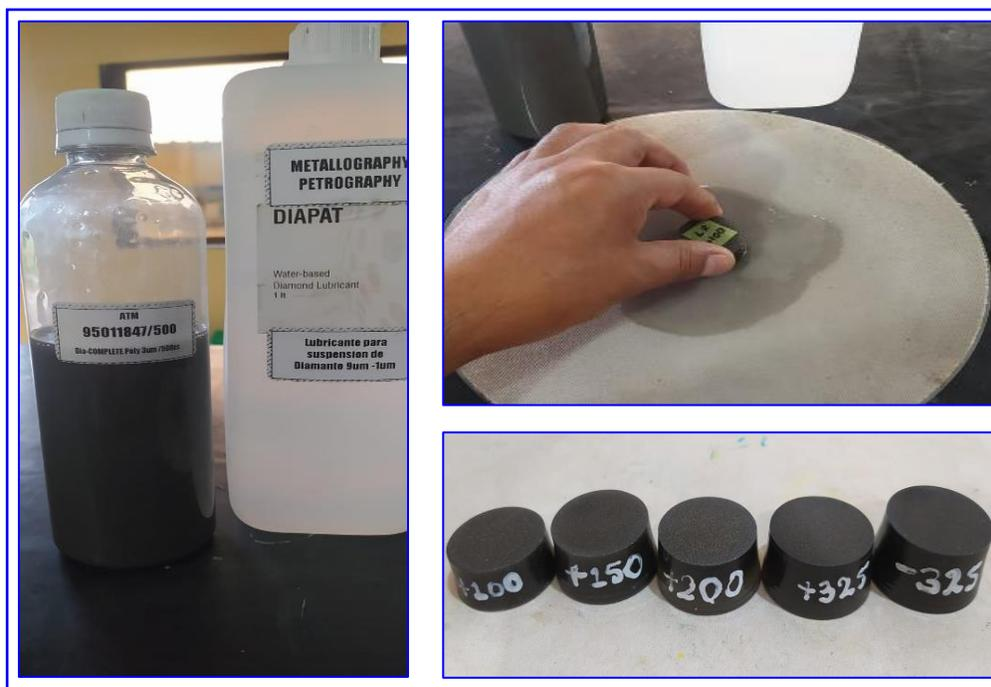
*Nota.* En la figura se observa la suspensión de diamante, lubricante y paño utilizados para pulir las briquetas. En la parte inferior derecha se observa las cinco briquetas elaboradas para el análisis mineralógico.
