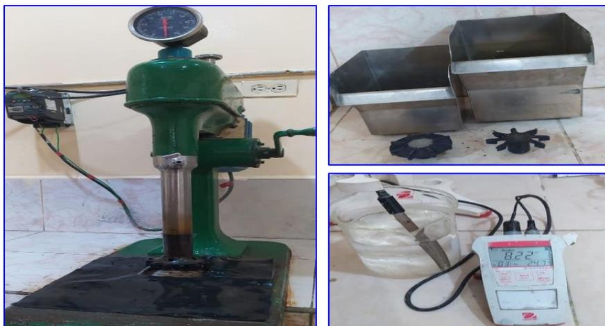
*Nota.* En la imagen se observa el equipo de flotación y las celdas respectivas utilizadas para las pruebas de flotación. También se observa el medidor de pH de la marca OHAUS ST-300.
