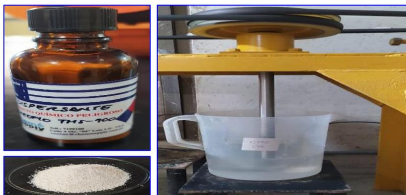
*Nota.* Se observa la muestra de carboximetil celulosa (CMC) marca REOFLO TMS-100 y el equipo agitador usado para su preparación.
