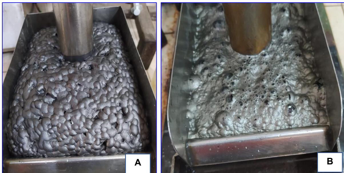
**Nota. A:** En la imagen se observa la espuma de la prueba de flotación con dosificación de 250g/TM de CMC. Se observa una espuma muy densa con coloración gris oscuro por la presencia de grafito.
