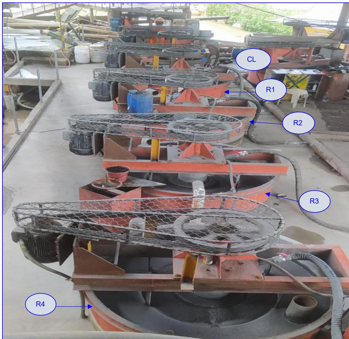
Nota. Se observa el circuito de flotación constituido por un tanque acondicionador de reactivos, visto en la parte superior; una celda limpieza (CL) y cuatro celdas rougher (R1, R2, R3, R4).
