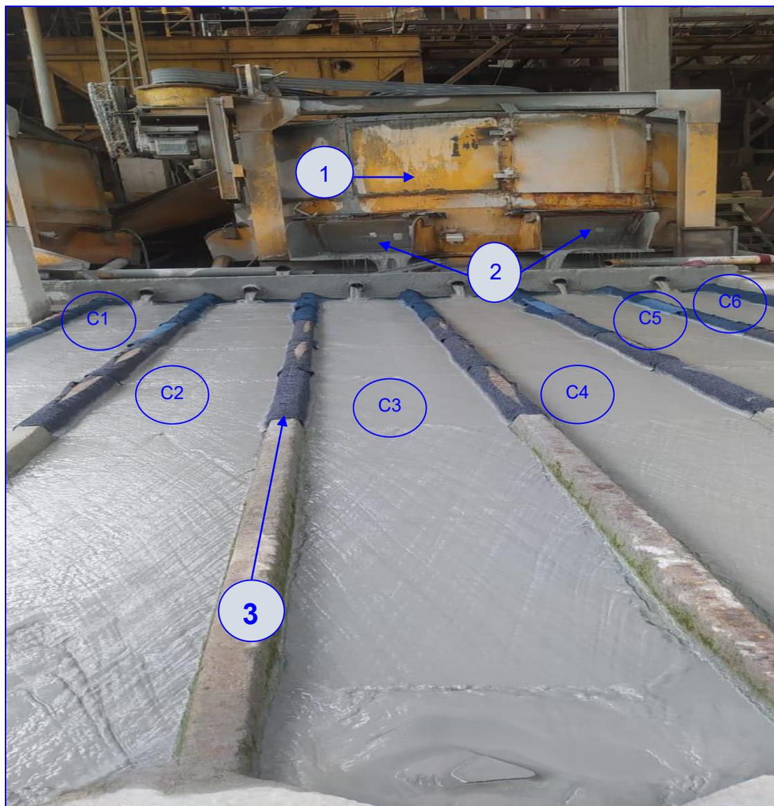
*Nota.* En la parte superior observa un molino chileno (1) con compuertas (2) con malla de evacuación de mineral molido y seis canales (C1, C2, C3, C4, C5 y C6) por donde fluye la pulpa de mineral. En estos canales se han extendido bayetas (3) para la retención de oro grueso liberado en la molienda.
