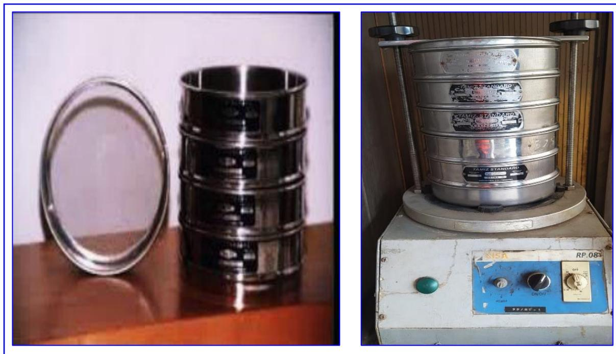
*Nota.* En la imagen se observa el conjunto de tamices y Ro-Tap utilizado para la clasificación granulométricas.
