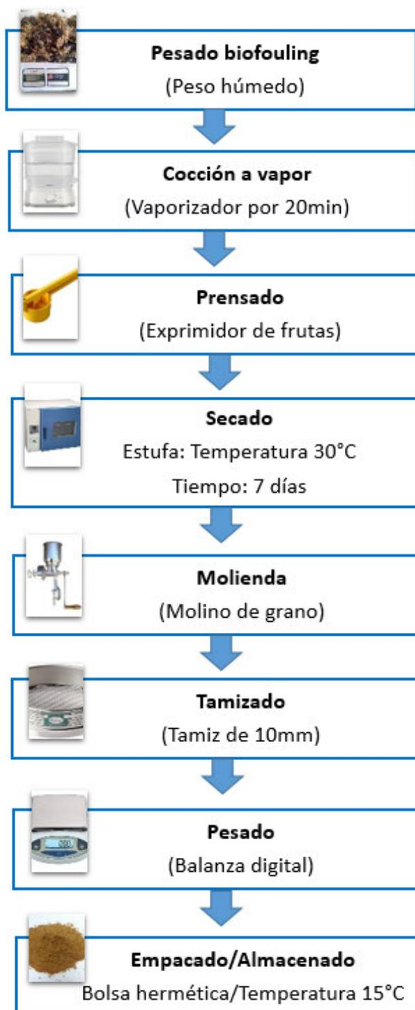
*Figura 14.* Flujograma de producción de harina de biofouling con la técnica biofouling al vapor.
