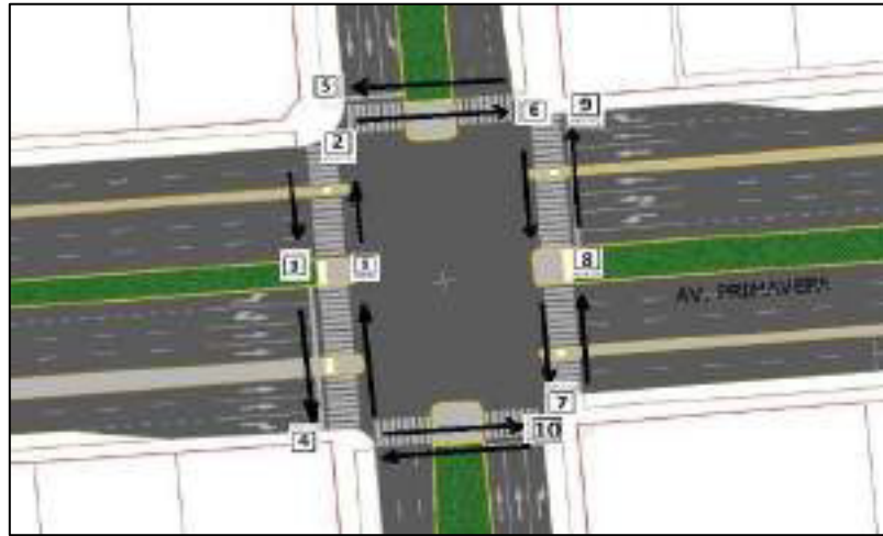
Figura 46. Semáforos ubicados en la intersección
