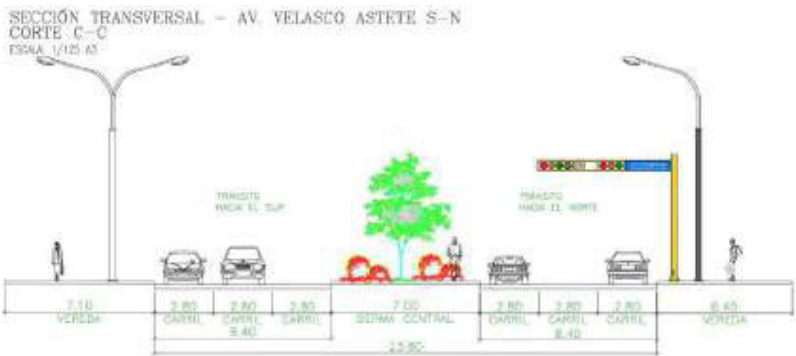
Figura 61. Sección transversal – Av. Velasco Astete S – N
