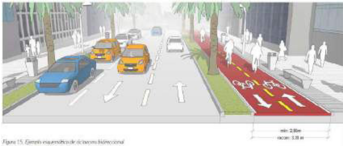
Figura 86. Anchos de carril de diseño para ciclovías en berma lateral
