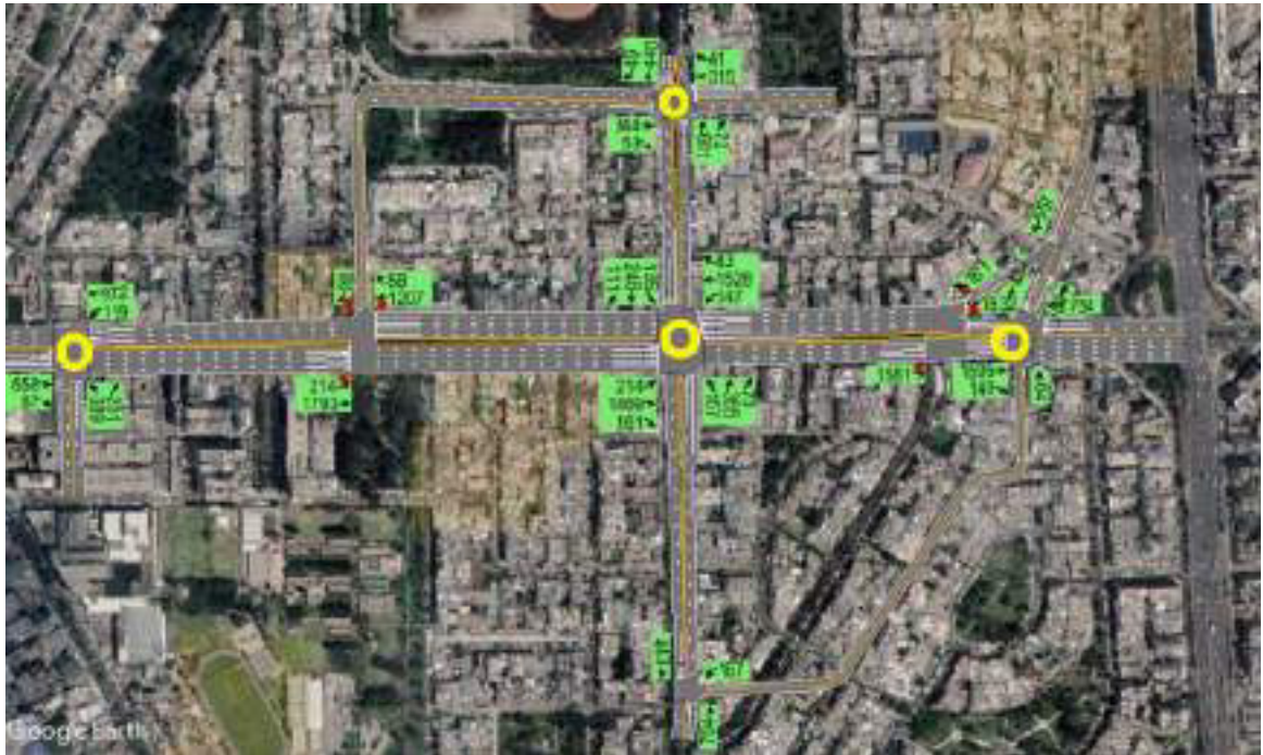
Figura 76. Modelo de simulación de tránsito – puntos de inflexión
