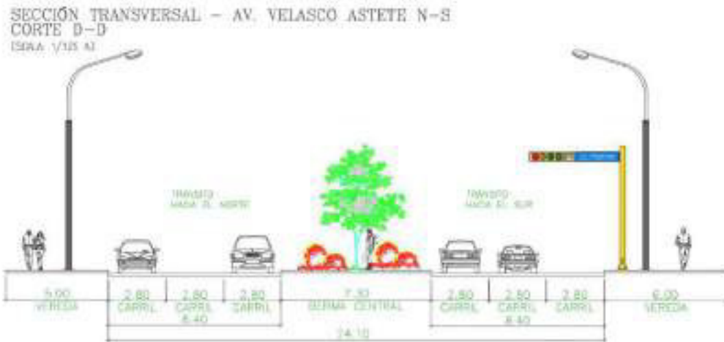
Figura 62. Sección transversal – Av. Velasco Astete N – S
