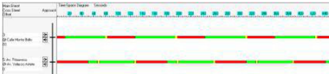
Figura 79. Sincronización de semáforos – punto 7
