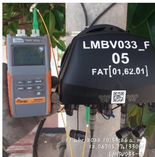
Figura 44: Medición Power Meter (FAT 05). Fuente: CNSIC
