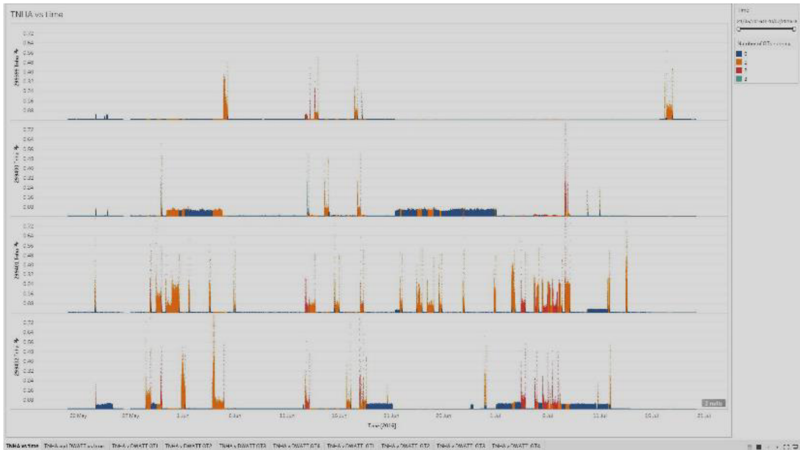
Figura 8 TNHA frente al tiempo del 21 de mayo al 20 de julio coloreado por el número de GT en funcionamiento
