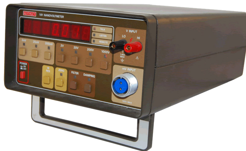
Figura 3.20: Keithley 181 es un Nanovoltímetro muy sensible con GPIB IEEE-488 [34]
