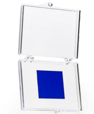
Figura 4.18: Película de Grafeno sobre SiO_2
