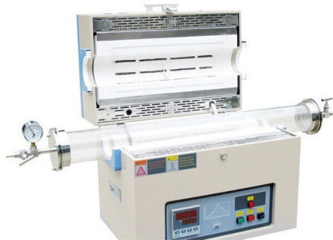
Figura 3.7: Horno tubular para la deposición química de vapor(CVD).
