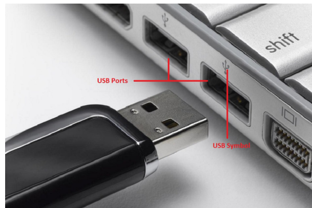
Figura 3.16: USB permite que una computadora se comunice con periféricos de computadora y otros dispositivos.
