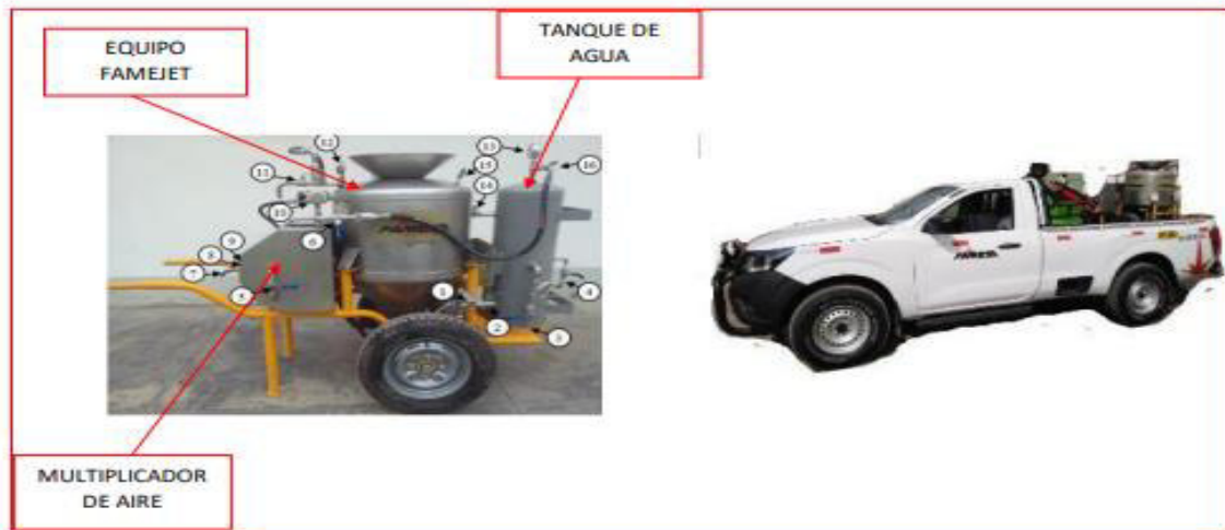
Figura 11 Sistema de bombeo Mecanizado para EMULGRAN QHANA
