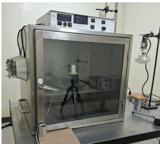
Figura 21 IRUVAB conectado a radioespectrofotómetro para medición de la irradiancia UVA-B emitida en la cámara a 18 cm de la fuente de la lámpara UV. Fuente: Elaboración propia.
