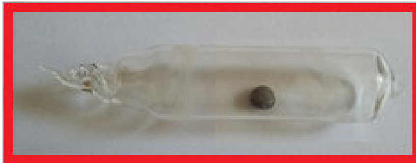
Figura 3.5. Muestra de estudio encapsulada en tubo de cuarzo.
