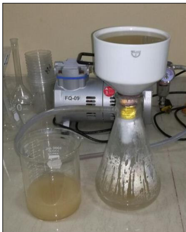
Figura 32. Filtración de solución con contenido de maltodextrina
