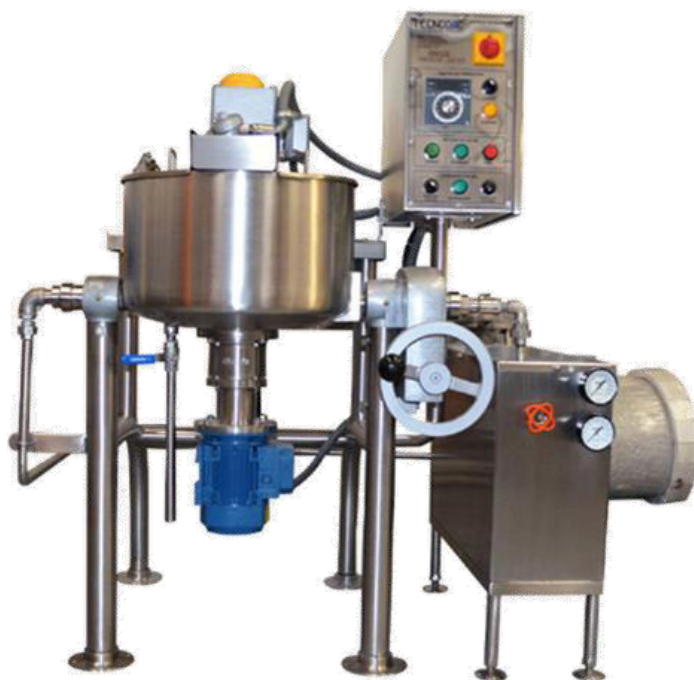
Figura 44. Marmita con chaqueta para procesamiento de subproducto barra energética. Fuente: Catálogo Tecnodac
