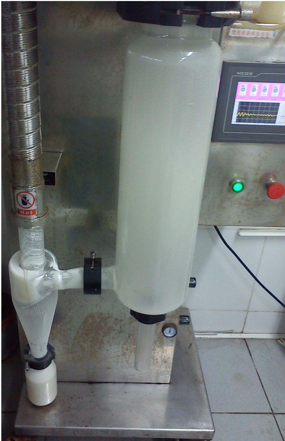
Figura 16. Foto del equipo de secado por atomización utilizado para los experimentos. Propiedad de la empresa Molinos Asociados S.A.C.
