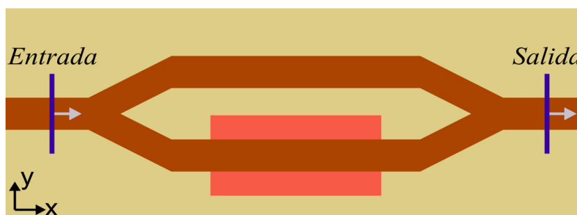
Figura 5.10: Configuración de puertos en el interferómetro para el estudio de transmisión del modo TE. Fuente: Elaboración propia.
