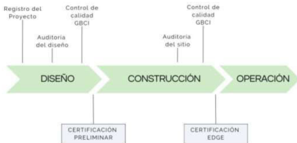
Figura 2: Proceso para obtener la certificación EDGE. Fuente: Elaboración propia.
