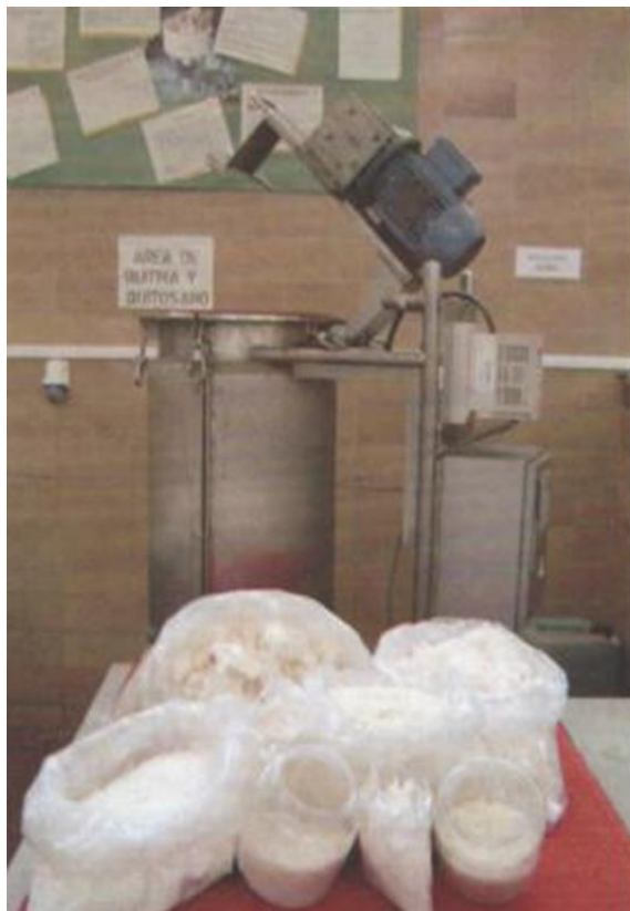
Figura 8. Reactor de acero inoxidable 80L y quitosano obtenido Ing. Mecánica-PUCP.
