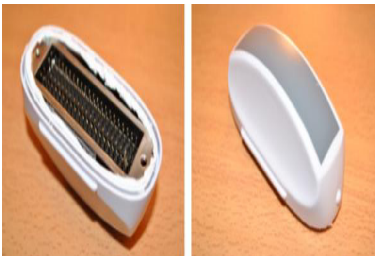
Figura 9: Fotografía del cabezal piezoeléctrico utilizado. Fuente: Elaboración propia.
