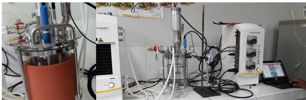
Figura 2. Bioreactor tipo BIOSTAT A de Sartorius
