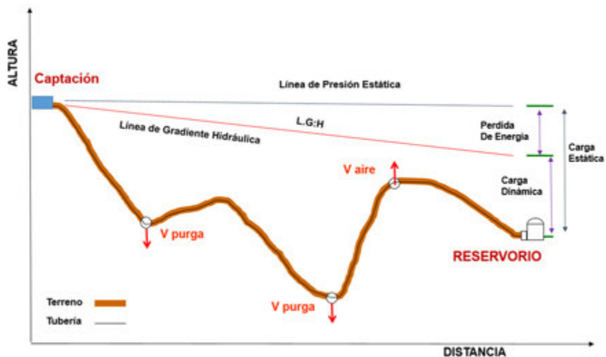
Figura 5. Características de la línea de conducción.
