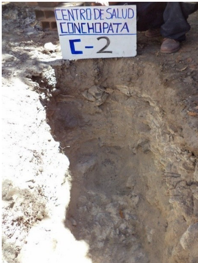
Figura 3.12: Toma fotográfico de la Estratigrafía de la calicata C-2
