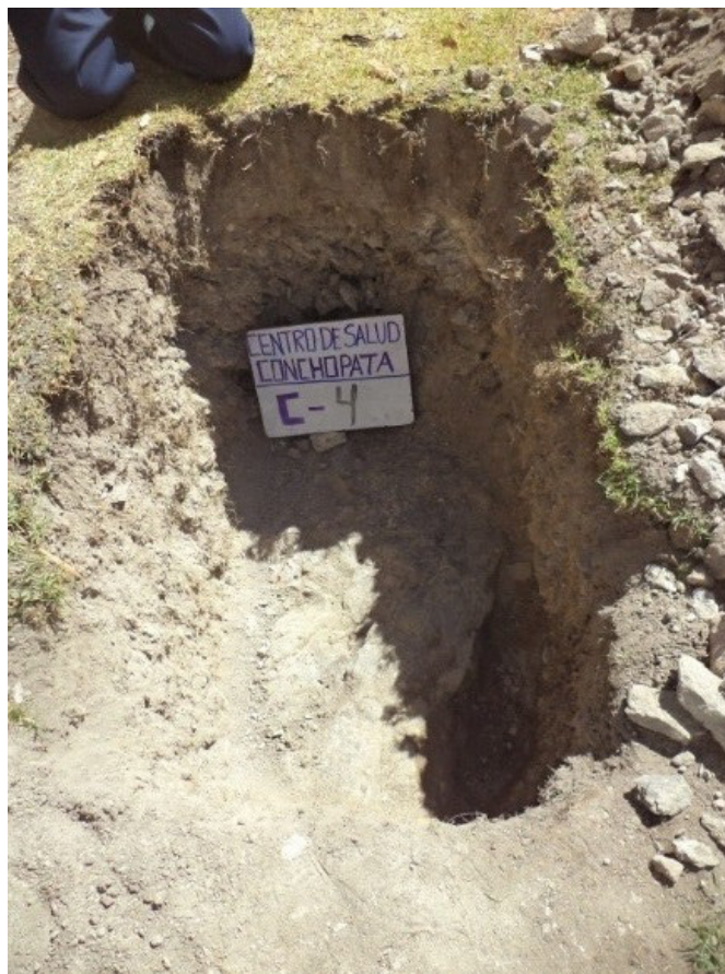
Figura 3.14: Toma fotográfico de la Estratigráfía de la calicata C-4
