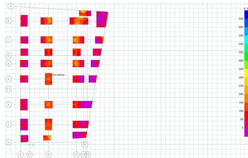
Figura 3.37: Cálculo de Acero de zapatas-Eje X
