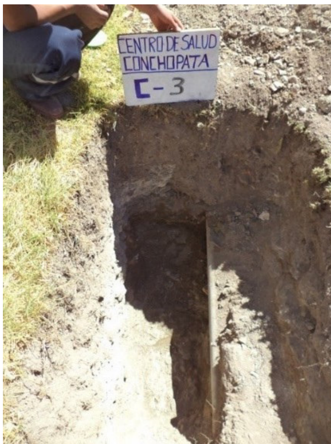
Figura 3.13: Toma fotográfico de la Estratigrafía de la calicata C-3
