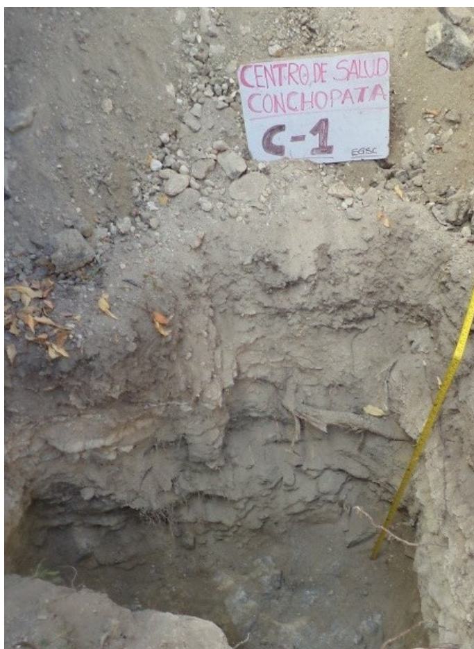
Figura 3.11: Toma fotográfico de la Estratigrafía de la calicata C-1
