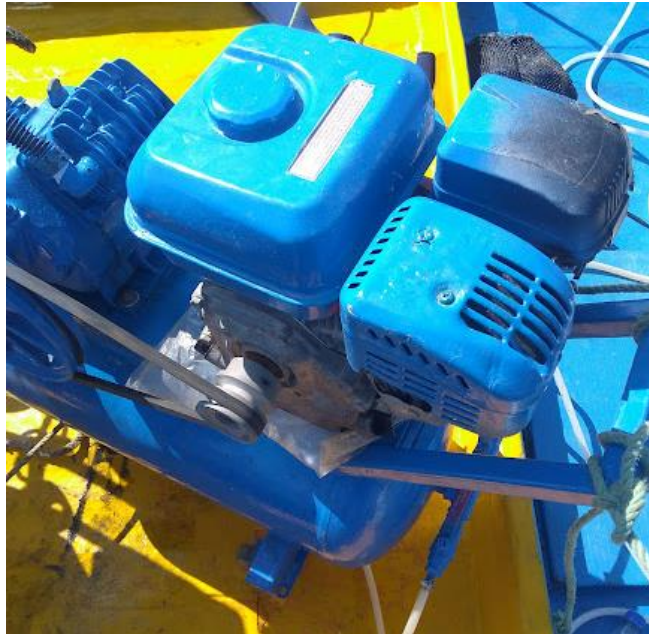
Figura 1. Compresor de aire para buceo. El tubo del regulador se conecta a la compresora por uno de los orificios y se bombea aire al momento de encenderlo
