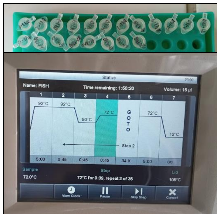
Figura 4. Arriba: tubos eppendorf con solución de PCR listos para ser amplificados. Abajo: Termociclador Thermal cycler, indicando los ciclos de la PCR.
