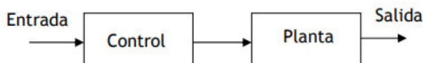
Figura 2- Esquema de un Sistema de control de lazo abierto Fuente. Figura tomada de Ortega (2015)
