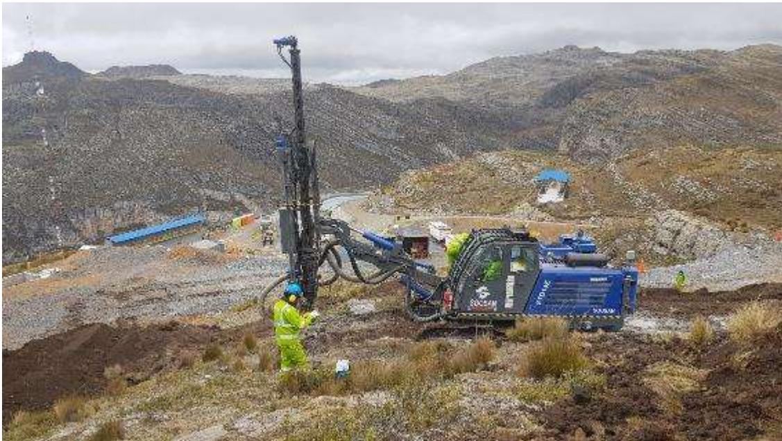
Perforación con equipo mecanizado hidraulico en plataforma
