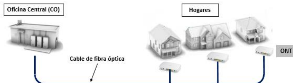
Figura 14: Fibra hasta el hogar. Fuente: Elaboración propia
